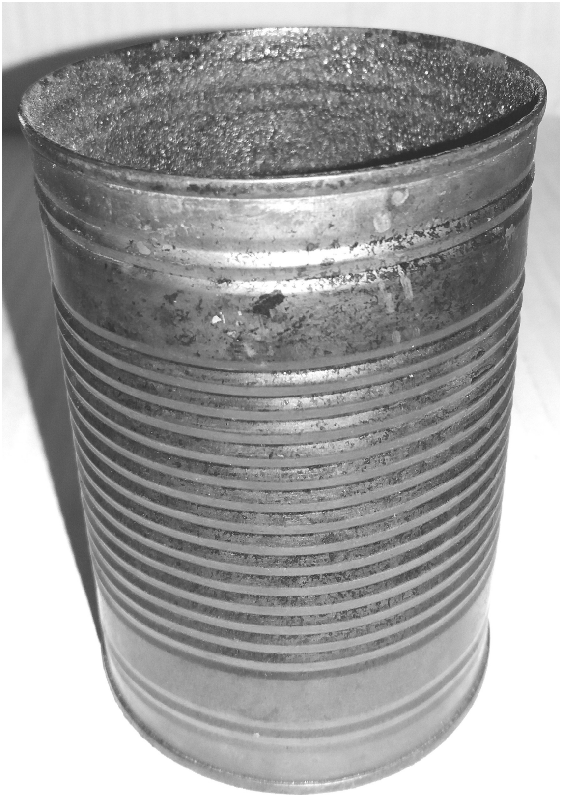
Abbildung 14: 75er-Dose (75 mm Durchmesser, ca. 108 mm Höhe), stapelbar oder nicht-stapelbar, ausgebrannt, als Brennkartusche für Holzpellets oder Steckholz. Die Ansicht der stabilisierenden Sicken / Verprägung wird innen von einer Schicht Holzteer verdeckt. Auch das zweite Kaminsegment wird aus einer 75er-Dose gefertigt.
