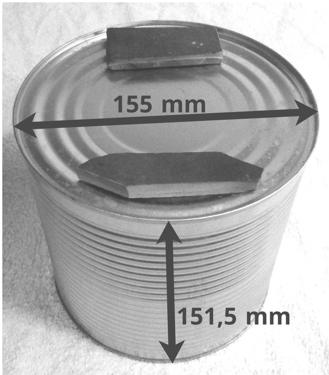
Abbildung 51: Gastronomiekonservendose, gleicher Durchmesser wie die Dose für den Öfchen-Container, Variante mit geringerer Höhe, kann mit zwei Fliesenstreifen (gegen Wegrollen) als Untersatz zum Ausbrennen der für den Bau des Öfchens benötigten Konservendosen verwendet werden.
