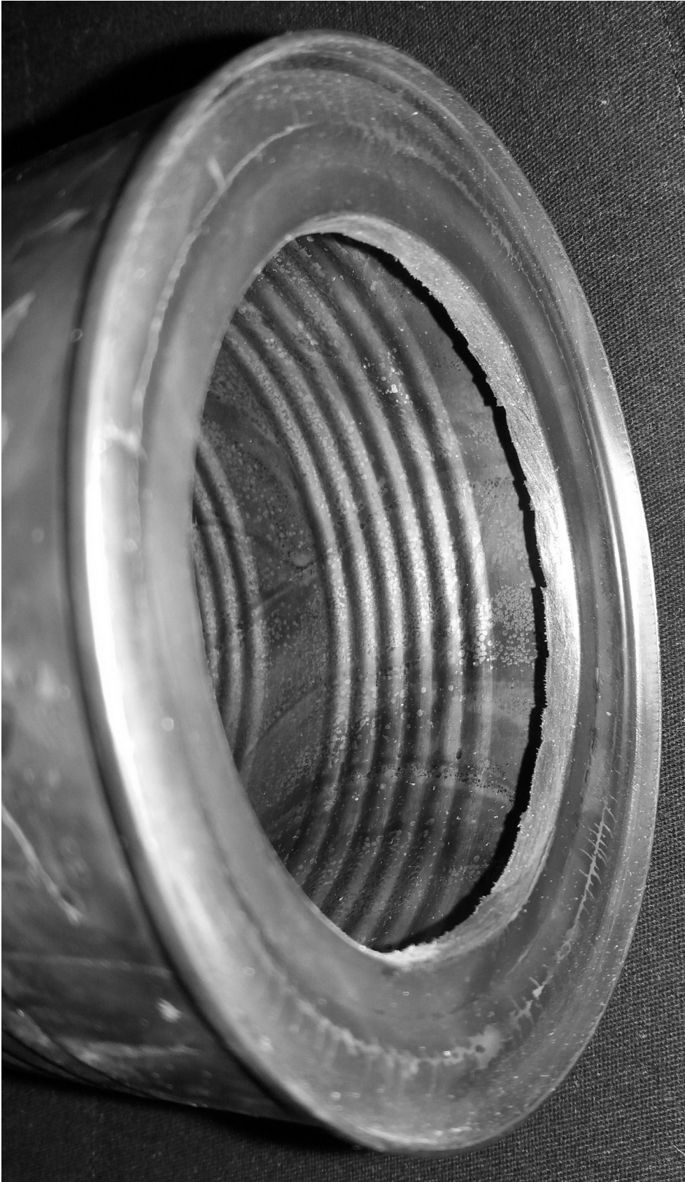
Abbildung 19: 100er-Dose, gefalztes Rundblech der großen Stirnseite von außen. Konzentrische Kreisöffnung von 60 oder 70 mm Durchmesser für Kapselunterteil, erstes Kaminsegment, oder Kapseldeckel. Innenrand steht nach Umformen senkrecht.
