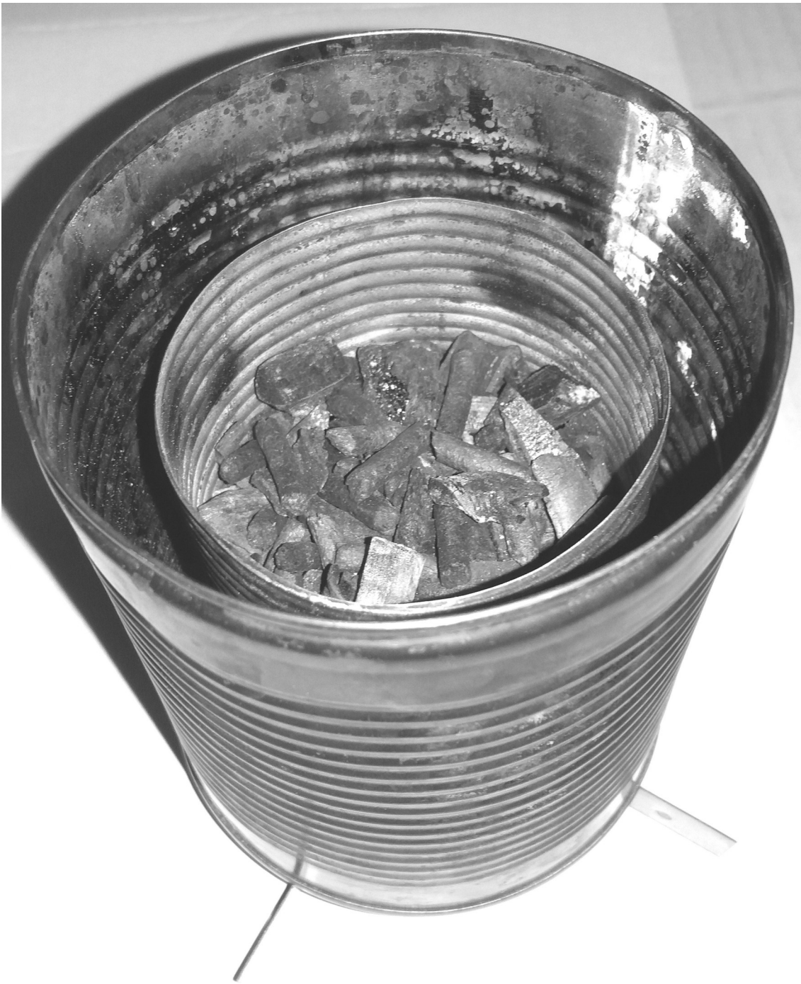
Abbildung 67: Das Kapselunterteil des Heizöfchens kann im Holzkohlenkocher verwendet werden. Innerhalb des Kapselunterteils, auf dem Ständerkreuz aufsitzend, eine abgeschnittene 75er-Dose als Holzkohlenkochkartusche (siehe auch Abb. 70 und 71). Der vertikale Abstand des oberen Kartuschenrands zum Ringblech des Kapseldeckels soll mindestens 20 mm betragen.
