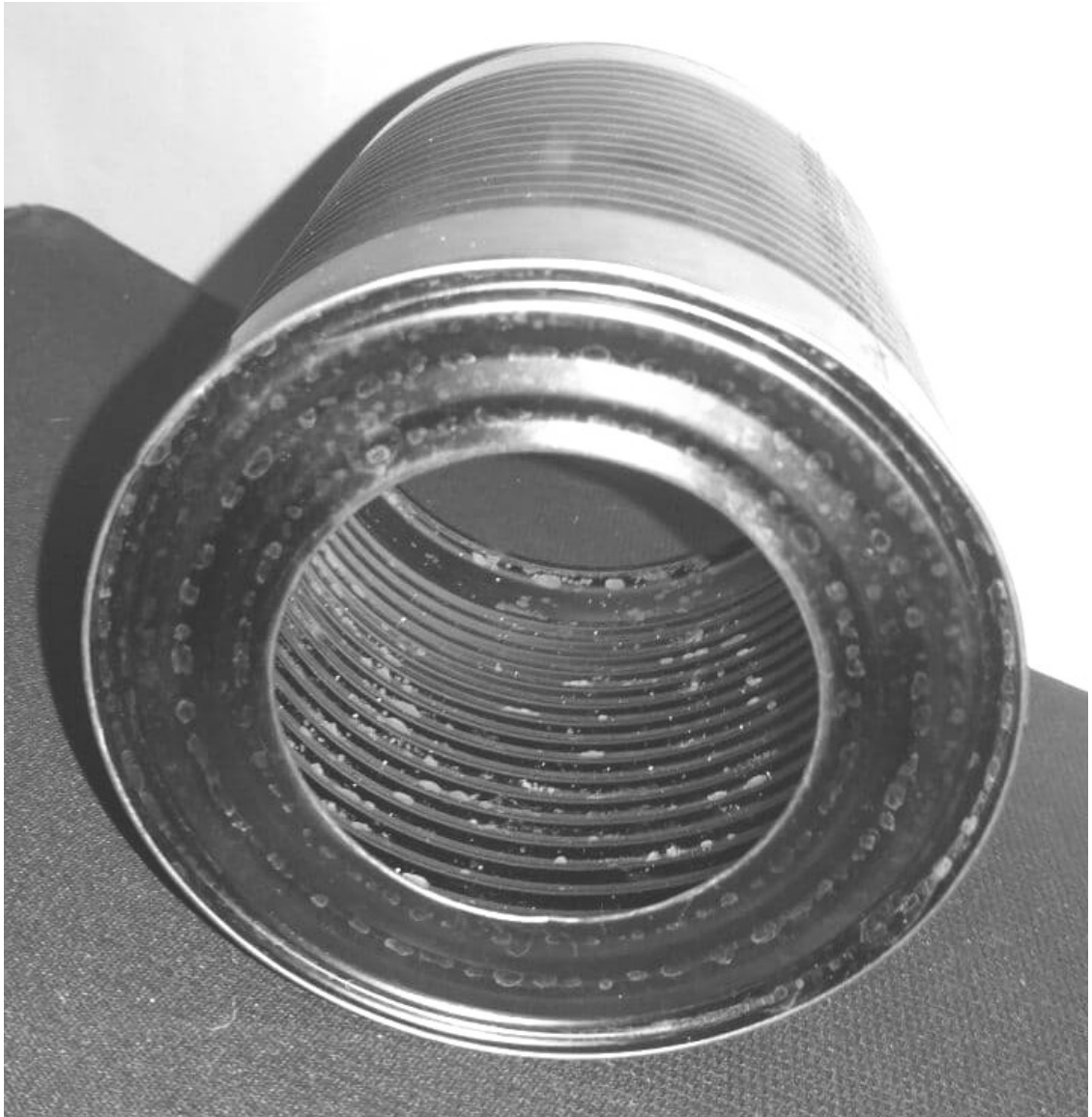
Abbildung 22: 100er-Dose (100 mm Durchmesser, 119 mm hoch), ausgebrannt, Außenansicht der großen Stirnseite mit zentralem Rundloch von ca. 60 mm Durchmesser. Von diesem Werkstück werden für das Mini-Holzvergaseröfchen zwei Ausfertigungen benötigt. Das Teil kann bereits als fertiges unteres Kaminsegment dienen (sofern stapelbar!). Ein weiteres Exemplar wird zum Kapselunterteil ("stapelbar-spezial" erforderlich!) weiterverarbeitet. Hierfür wird ein doppeltes Ständerkreuz (Innenteil und Außenteil) am 60er-Rundloch angebracht (Abb. 6 bis 9). Für den Kapseldeckel kann sogar eine nicht-stapelbare 100er-Dose verwendet werden, welche ein zentrales Rundloch von 70 mm Durchmesser erhält. Für die Weiterverarbeitung zum Kapseldeckel wird die Dose am Mantel rundherum abgesägt (in der Höhe reduziert, Abb. 23 und 24).
