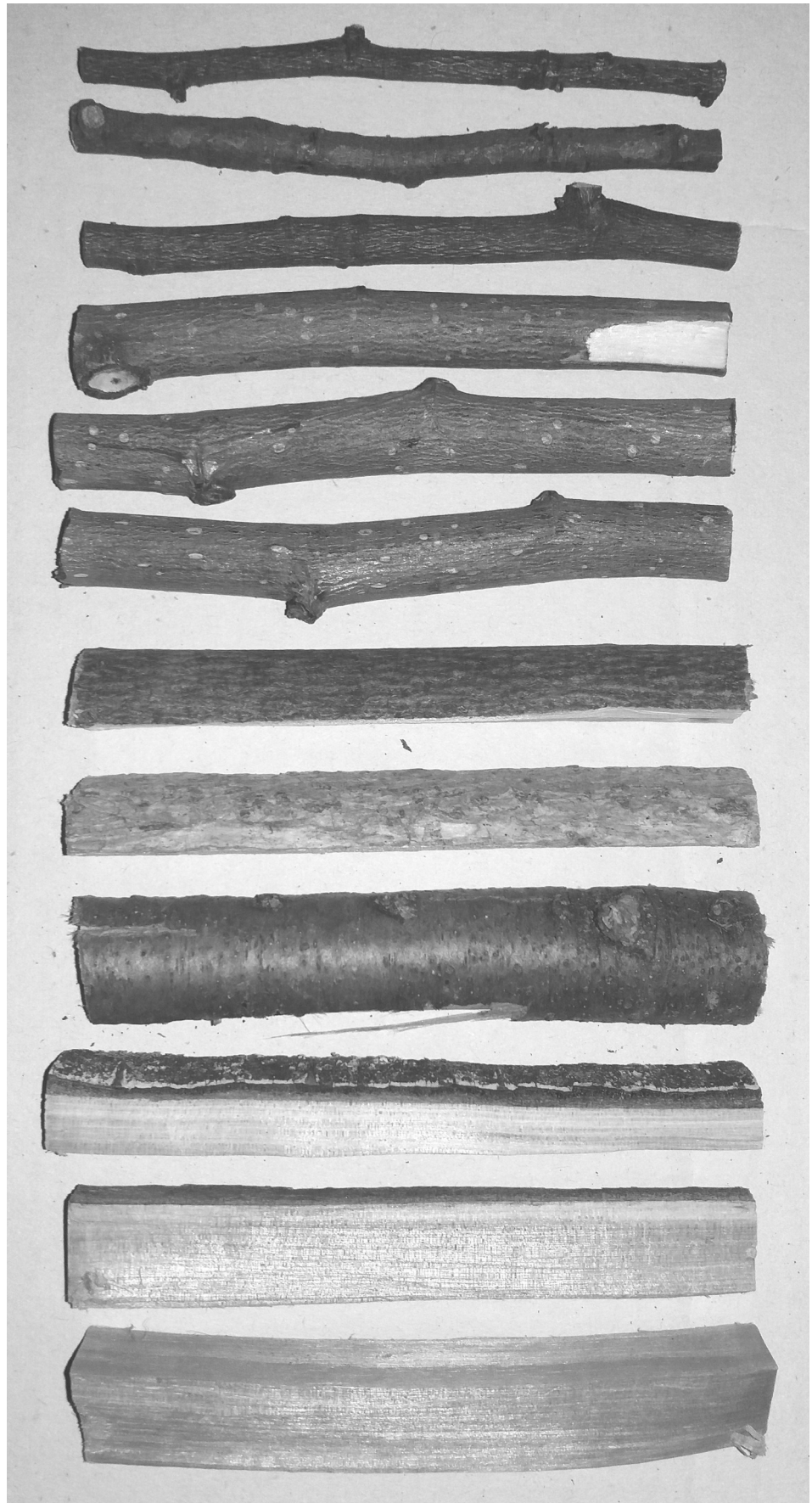
Abbildung 40: Holzstifte, 10 cm Länge. Runde, halbrunde und eckige Profile.
