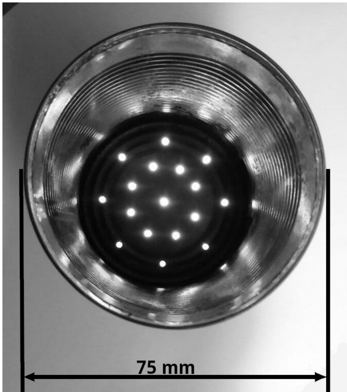
Abbildung 29: 75er-Dose (75 mm Durchmesser, ca. 108 mm Höhe), stapelbar oder nicht-stapelbar, ausgebrannt, als Brennkartusche für Holzpellets oder Steckholz, Innenansicht. Um das zentrale Loch am Kartuschenboden liegen drei konzentrische Kreise, auf denen je acht weitere Löcher äquidistant angebracht werden. Der innere Kreis hat einen Radius von 15 mm (Durchmesser 30 mm). Für das Anzeichnen des Innenkreises lohnt sich die Anfertigung einer Schablone (Abb. 32). Die äußeren Kreise werden nach Augenmaß so angebracht, daß die Holzcharge von der gesamten Kreisfläche her gleichmäßig Luft bekommt. Die konzentrische Profilierung des runden Stirnseitenbleches zum Rand hin macht hier die Verwendung einer Schablone überflüssig. 8 + 8 + 8 + 1 in der Mitte macht 25 Löcher (hier abgebildet die alte Version mit 17 Löchern), angebracht mit einem Nagel von 2 mm Durchmesser (mit einer Schieblehre nachmessen!). Der Schwelbrand darf nicht zu viel und nicht zu wenig Luft bekommen und das möglichst gleichmäßig (Gleichverteilung der Luftlöcher). Immer sorgfältig anzeichnen und maßhaltig arbeiten!
