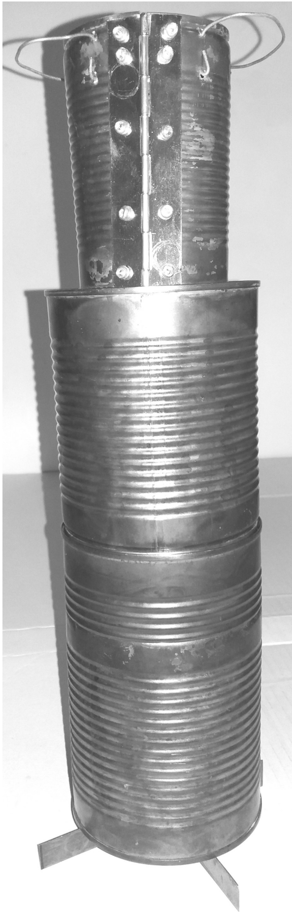
Abbildung 1: Öfchen ohne Container. Die einzelnen Bauteile in der Reihenfolge von unten nach oben: Ständerkreuz, Kapselunterteil, Kapseldeckel, erstes Kaminsegment, zweites Kaminsegment mit Klavierband (Scharnier) und wärmeisolierten Henkeln.
