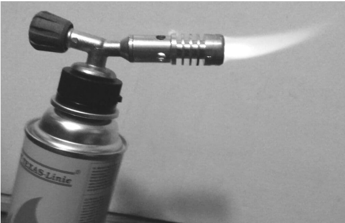
Abbildung 52: Lötbrenner, zum Ausbrennen der Konservendosen, adaptiert, auf Asia-gaskartusche in Aktion.
