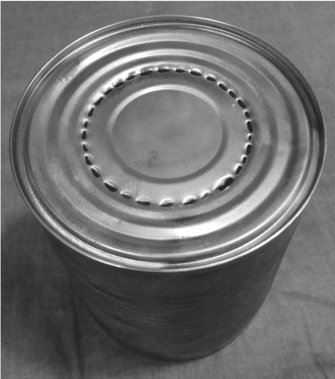
Abbildung 17: 100er-Dose (100 mm Durchmesser, 119 mm hoch), per Taschenmesser (Feststellklinge!) perforiert für die Herstellung des zentralen 70er/60er-Rundloches an der großen Stirnseite. Das kreisförmig-konzentrische, stabilisierende Prägeprofil bietet visuelle Hilfe. Der perforierte Kreis ist etwas kleiner. Später wird der Kreis durch Umbördeln der Kante aufgeweitet. Alle drei 100er-Dosen für die Mini-Holzgasheizung für drinnen benötigen diese Öffnung auf der Stirnseite mit dem großen Kreis. Der Kapseldeckel kann sogar von einer nicht stapelbaren Konservendose abgesägt werden. Das erste Kaminsegment benötigt eine stapelbare 100er-Dose, diese braucht aber keine ausgeprägte Verjüngung zum kleinen Stirnseitenkreis hin. Lediglich das Kapselunterteil erfordert die Dosenvariante "stapelbar-spezial".
