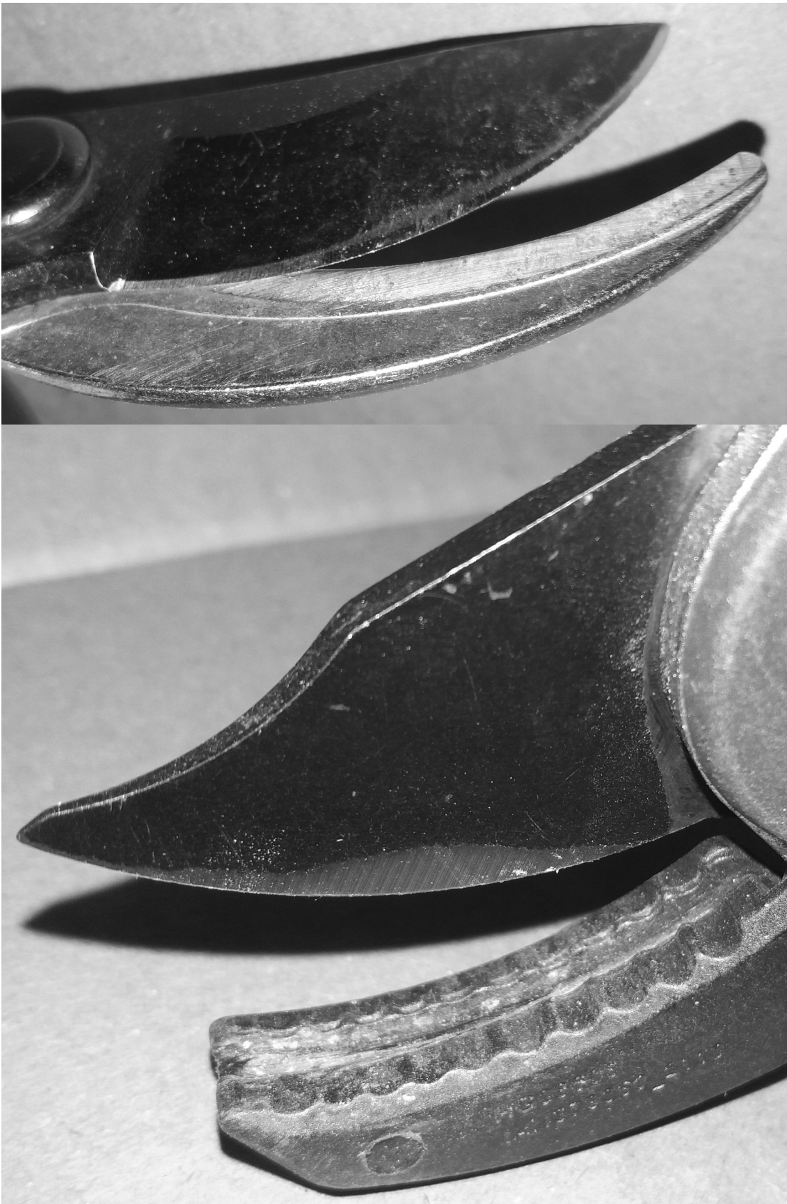
Abbildung 59: oben Gartenschere Scherprinzip, unten Gartenschere Amboßprinzip.
