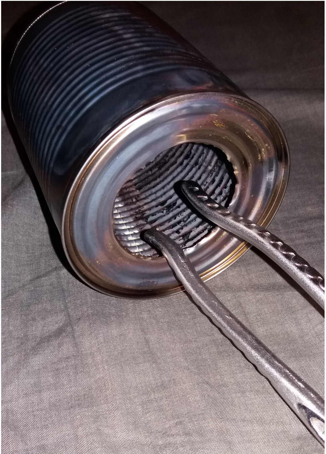
Abbildung 18: 100er-Dose, ausgebrannt, Kreisdeckelblech der großen Stirnseite von außen. Herstellung der konzentrischen Kreisöffnung von 60 oder 70 mm Durchmesser. Nach dem Heraustrennen des runden Mittelbleches per Taschenmesser und Schraubenzieher wird der Rand vorsichtig mit Hilfe einer Chrom-Vanadium-Wasserpumpenzange umgebördelt.
