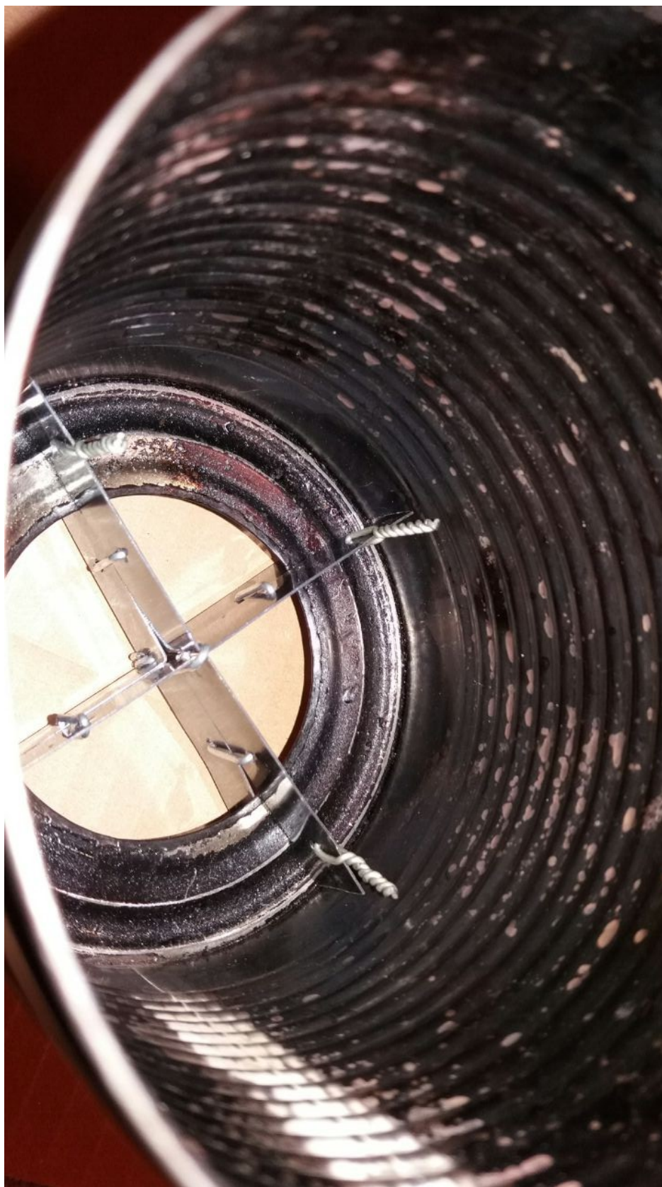
Abbildung 7: Kapselunterteil, 100er-Dose, “stapelbar-spezial”, ausgebrannt, Ansicht von oben. Die aus dem oberen Ständerkreuz aufragenden Drahtwendeln repräsentieren die Stopper, welche verhindern, daß die Kartusche zu nah an den Rand der Kapsel gerät.
