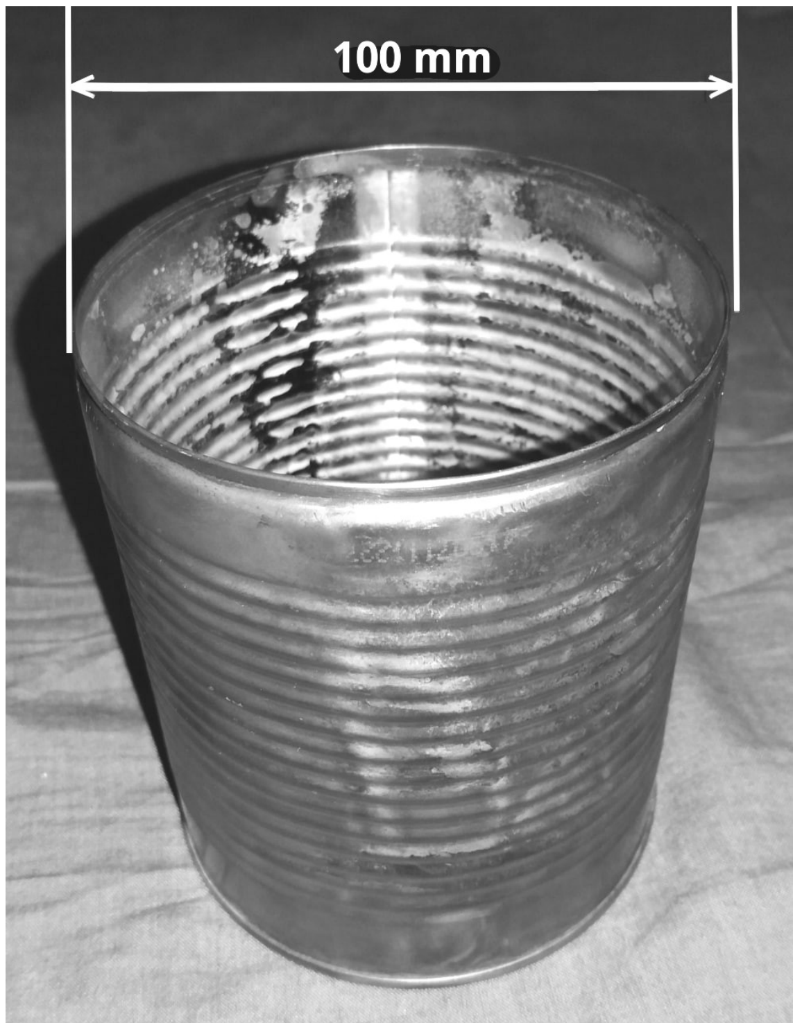
Abbildung 3: Konservendose, Höhe 119 mm, Durchmesser 100 mm (im Folgenden kurz 100er-Dose genannt), stapelbar, ausgebrannt, offen auf der Stirnseite mit dem kleinen Kreis (stapelbare Konservendosen haben je eine kleine und eine große kreis-förmige Stirnseite). Kaum sichtbar, gibt es bei den stapelbaren Dosen unterschiedliche Varianten bezüglich der Ausformung der Verjüngung zum kleinen Stirnseitenkreis hin. Der Kapseldeckel paßt nur auf die Varianten mit der ausgeprägteren Verjüngung, im Folgenden " stapelbar-spezial " genannt, was die Wahl einer Dose für das Kapsel-unterteil auf diesen Typ einschränkt.
