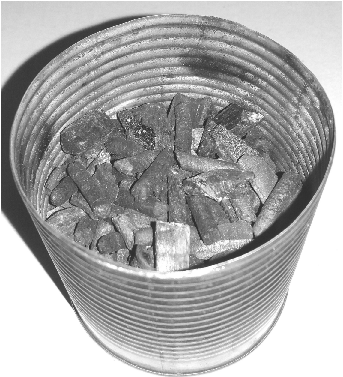
Abbildung 70: 75er-Dose (75 mm Durchmesser, ca. 108 mm Höhe), stapelbar oder nicht-stapelbar, ausgebrannt, als Holzkohlenkocher-Kartusche, dergestalt abgesägt, daß der vertikale Abstand des oberen Kartuschenrandes vom Ringblech des Kapseldeckels mindestens 20 mm beträgt. Hier zu zwei Dritteln mit Holzkohle befüllt.
