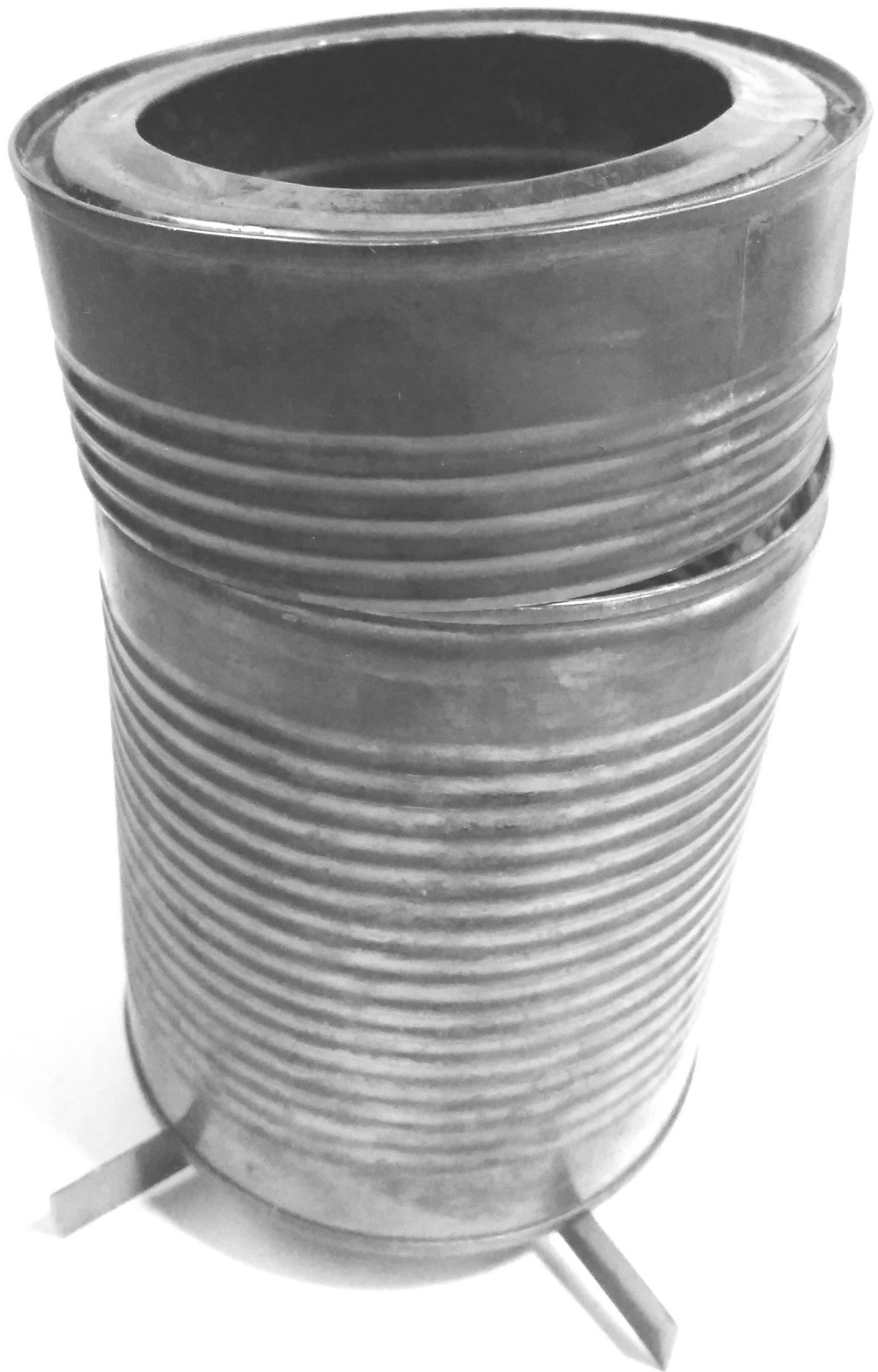
Abbildung 5: Der Kapseldeckel paßt nicht auf alle stapelbaren Konservendosen (kleiner Stirnseitenkreis, Kapselunterteil). Es gibt unterschiedliche Varianten! Während sich für das erste Kaminsegment alle stapelbaren 100er-Dosen eignen, muß für das Kapselunterteil die Verjüngung zum kleinen Kreis hin stärker sein ( “stapelbar-spezial” ).
