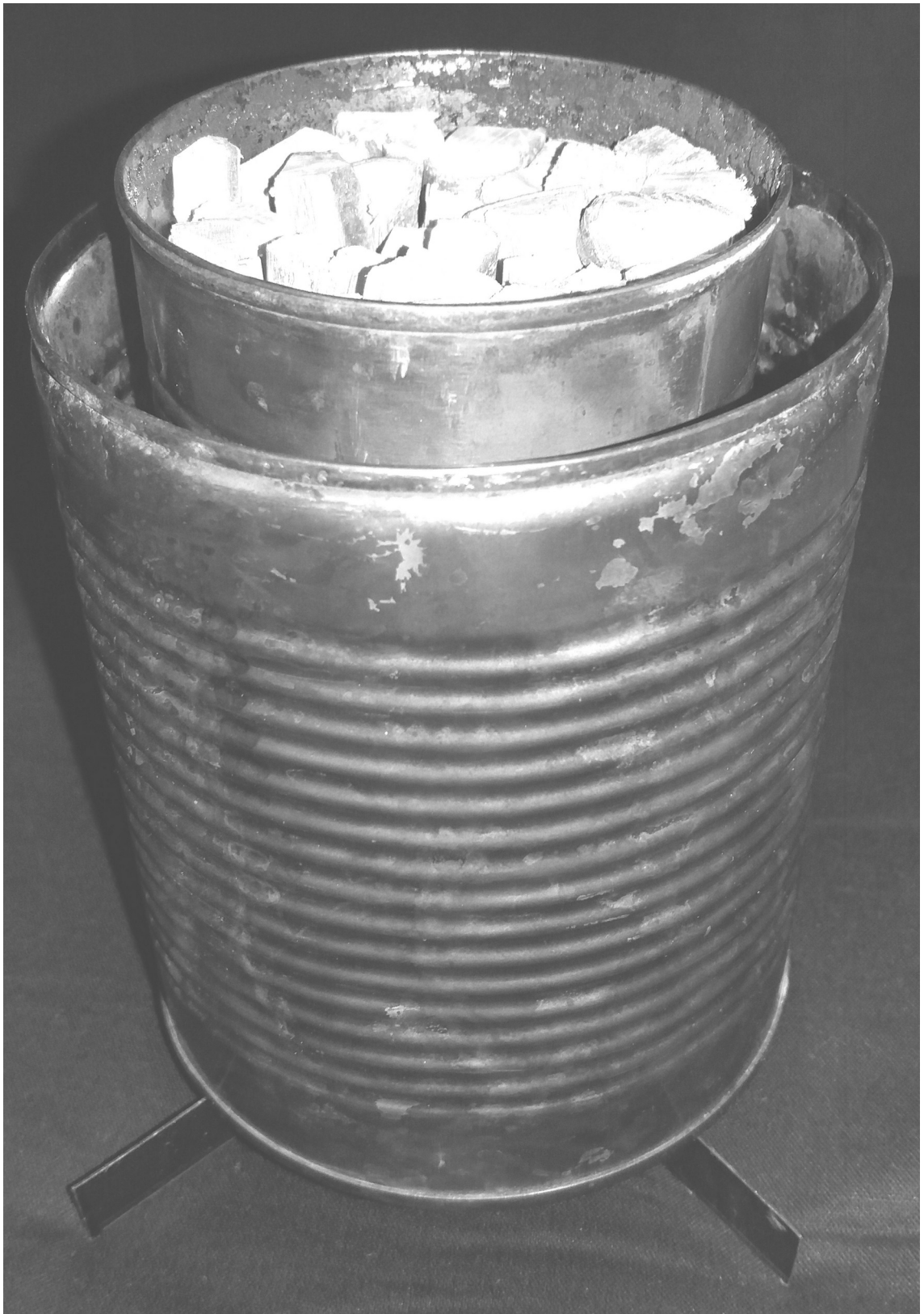
Abbildung 16: 75er-Dose, (75 mm Durchmesser, ca. 108 mm Höhe) stapelbar oder nicht-stapelbar, ausgebrannt, als Brennholzkartusche, hier befüllt und auf dem oberen Ständerkreuz im Kapselunterteil stehend. Die Kartusche ragt oben über den kleinen offenen Stirnseitenkreis des Kapselunterteils (100er-Dose, ausgebrannt, "stapelbar spezial") hinaus.
