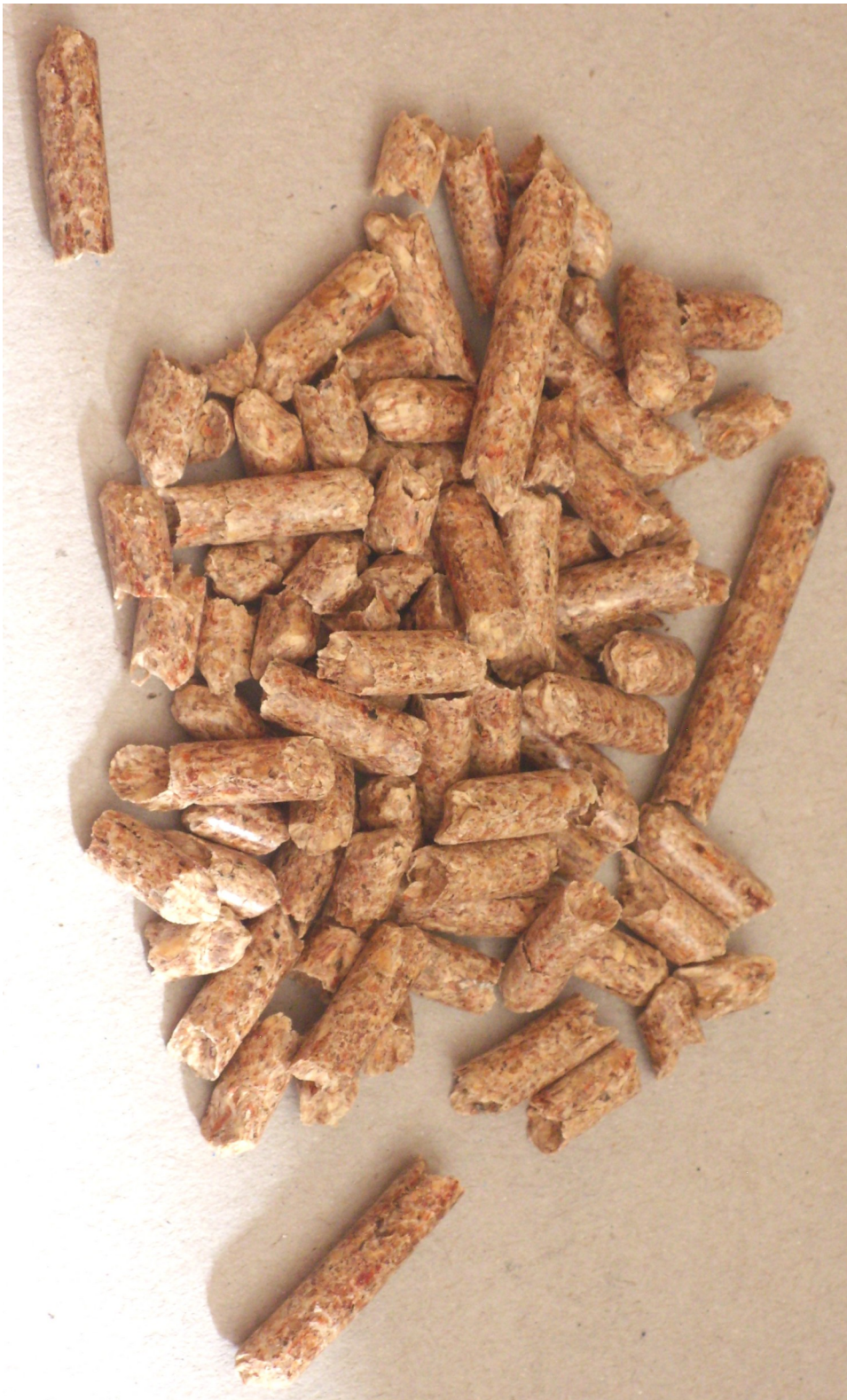
Abbildung 39: Brennstoffvariante Holzpellets (maschinell unter hohem Druck gepreßte Sägespäne), genormt, Durchmesser 6 mm, aus Laub- und Nadelholz, frei von Zusatz- und Bindemitteln, handelsüblich, verbreitet, preiswert. Zerbröselte und zu feinkörnige Pellets vom Grund eines fast leeren Gebindes verstopfen die Luftzufuhr innerhalb der Brennkartusche und müssen mittels eines Siebs und/oder durch Handverlesen ausgesondert werden.
