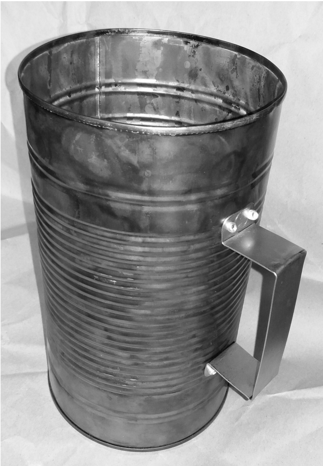
Abbildung 35: Öfchen-Container aus Gastronomiekonservendose (Höhe ca. 238 mm, Durchmesser ca. 155 mm), ausgebrannt, mit Handgriff, genietet.
