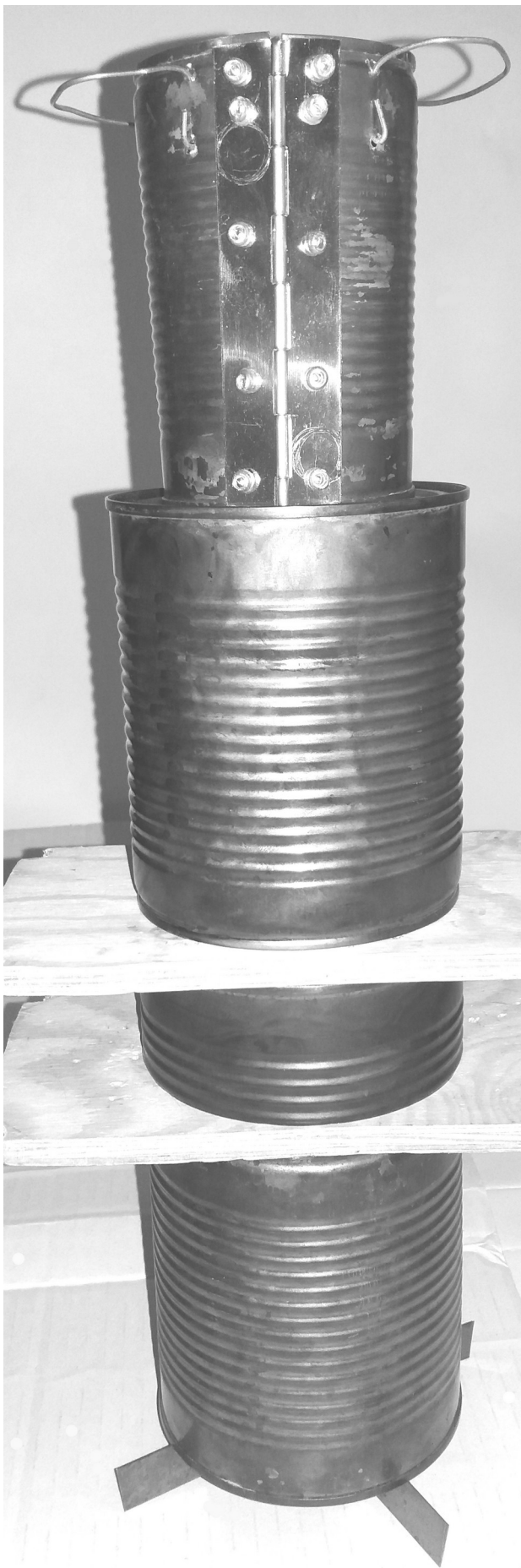
Abbildung 2: Öfchen ohne Container. Die einzelnen Bauteile in der Reihenfolge von unten nach oben, z.T. zur Veranschaulichung durch Sperrholzbrettchen separiert: Ständerkreuz, Kapselunterteil, Kapseldeckel, erstes Kaminsegment, zweites Kaminsegment mit Klavierband (Scharnier) und wärmeisolierten Henkeln.
