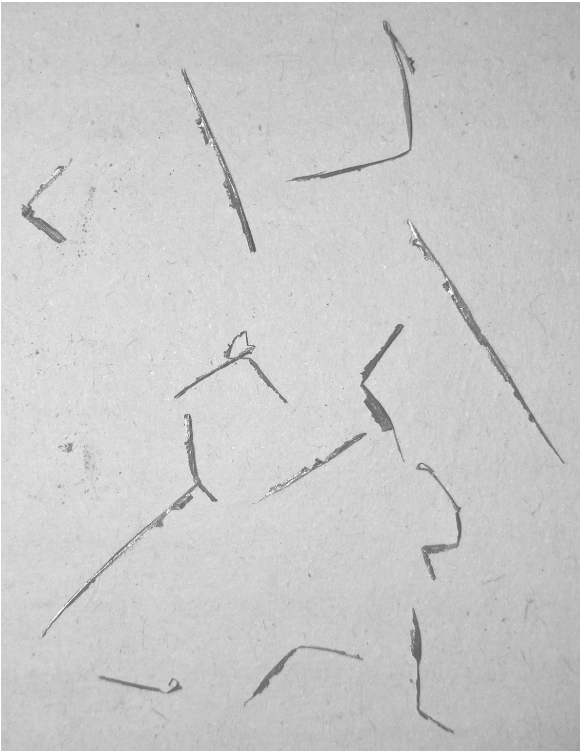
Abbildung 26: Die scharfkantigen Grate aus Abb. 25 nach Entfernen derselben mittels feinem Schleifpapier.
