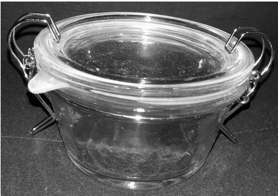
Abbildung 45: Glas mit Federverschluß und Gummidichtung (ca. 0,25 Liter) zum Einlegen und Aufbewahren der Holzhackstückchen in Brennspiritus.
