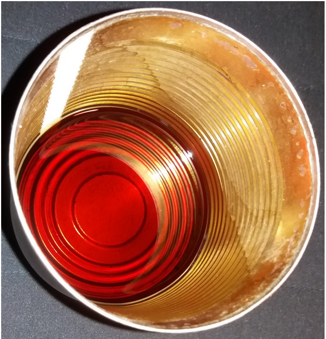
Abbildung 27: 100er-Dose (100 mm Durchmesser, 119 mm hoch) stapelbar oder nicht-stapelbar, mit oder ohne Abreißdeckel zwecks Öffnen, Öffnung möglichst am großen Stirnseitenkreis, nicht ausgebrannt, weil sie sonst undicht wird. Bei den aufreißbaren Varianten wird der schmale, senkrecht auf dem Mantel stehengebliebene Rundsteg per Dosenöffner entfernt. Die 100er-Dose mit intakter Lackschicht ist Bestandteil der neuen standardisierten Zündroutine für Holzstifte und dient als Behälter für die Ethanoltunke von (maximal) 25 mm Füllhöhe. 100er-Dosen mit Großkreisabreißdeckel sind zur Zeit die gängigste Variante und können für die Ethanoltunke verwendet werden. Für die Teile des Öfchens sind Dosen dieser Bauart leider nicht zu gebrauchen. Für die Brennkapsel (Deckel / Unterteil) und das erste Kaminsegment können wir leider nur die seltenen Ausfertigungen der 100-Dosen, also solche mit Kleinkreisabreißdeckel oder herkömmliche stapelbare Dosen, welche nur mittels Dosenöffner entleert werden können, verwenden. Der Kapseldeckel kann auch aus einer nicht-stapelbaren 100er-Dose gefertigt werden.
